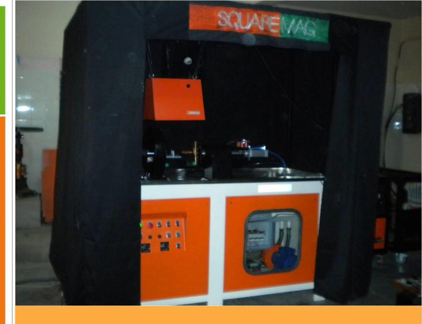
SEMI AUTOMATIC MPI EQUIPMENT FOR TURBINE BLADES TESTING,.
